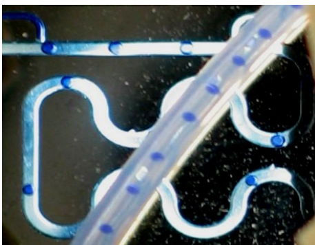
Abb. 1: Erzeugung von Kompartimenten im Chip; darüber Kapillarschleife mit eingebetteten Kompartimenten
